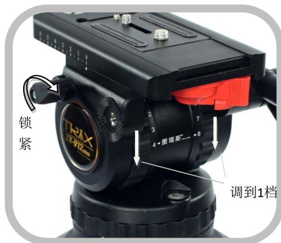
(2) 手握住云台手柄，松开“俯仰锁紧钮”和“滑板锁紧钮”，并前后滑动摄像机，直至将其达到水平方向的平衡，然后锁紧“滑板锁紧钮”和“俯仰锁紧钮”（记住滑板上的刻度，便于下次寻找平衡点）。
